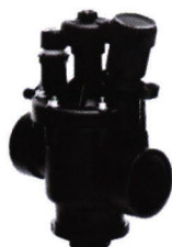
P220 ANGLE ET LIGNE, POIGNÉE DE RÉGLAGE DE DÉBIT CORPS NYLON RENFORCE FIBRE DE VERRE. FILTRATION COMMANDE : INOX 316. EZ-REG RÉGLAGE DE LA PRESSION AVAL À PARTIR DE 1,2m³/h. PS AVAL 0,3 à 7bars. PERTE DE CHARGE MINIMALE 0,7BARS.
