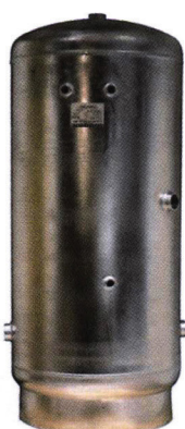
RESERVOIRS ACIER GALVANISE, PRESSION MAXI 6bars. RACCORDS tar 1/2" POUR MANO et 2 POUR GARNITURE DE NIVEAU, PURGE HAUTE ET BASSE, ENTREE ET SORTIES TARAUEDES.
