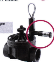
ICV PRESSION DE SERVICE MAXI 14bars. FIBRE DE VERRE, SIEGE ET MEMBRANE EPDM. POIGNÉE DE RÉGLAGE DE DÉBIT. VIS CAPTIVES. 3" ANGLE ET LIGNE. KIT MEMBRANE POUR EAUX CHARGÉES "FILTER SENTRY"
